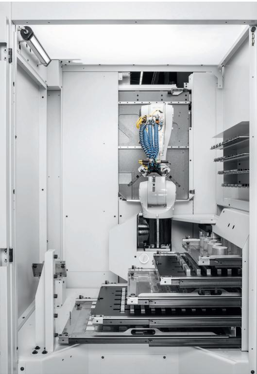
**2** Musste der Greifer bisher manuell verstellt oder gewechselt werden, um neue Werkstücke mit veränderten Dimensionierungen manipulieren zu können, erfolgt der Fingerwechsel und somit die Variabilität des Werkstückgreifens jetzt vollautomatisiert © Maik Goering/Hermle
